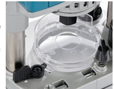
**HINDERLICH:** Geschlossene Absaugbecher erschweren den Fräserwechsel
