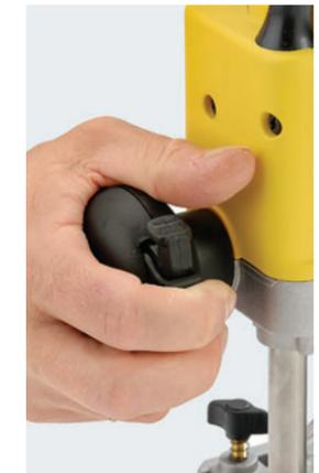
**SCHALTER:** Die Entriegelung erfordert bei DeWalt eine unergonomische Bewegung der führenden Hand
