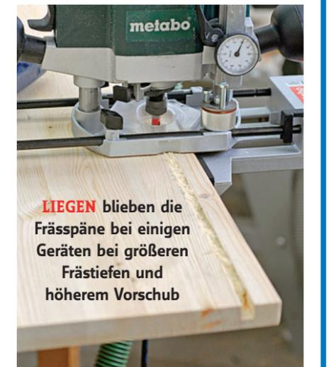
**LIEGEN** blieben die Frässpäne bei einigen Geräten bei größeren Frästiefen und höherem Vorschub
